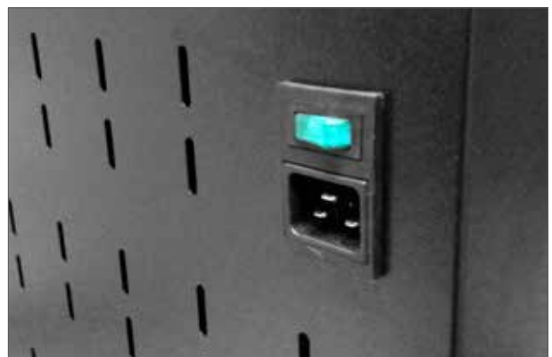
Bouton marche / arrêt coupant la charge et préservant les batteries.
